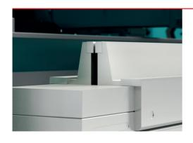
Опция MVM представляет собой матрицу с изменяемым V-образным пазом и является альтернативой устройству ATA.L. Данная опция автоматически корректирует раскрытие V-образного паза матрицы на основе программы и позволяет выполнять гибку материалов разной толщины и/или с разным радиусом гибки. Не требуется ручной переналадки матрицы, что повышает производительность и гибкость гибочного пресса.
