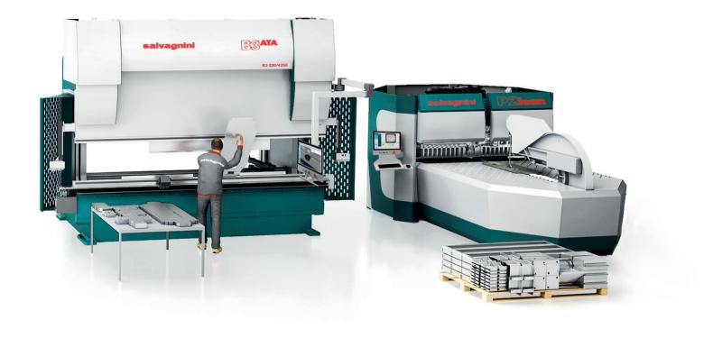
FlexCell: комбинация отдельных станков, которые обмениваются данными между собой с помощью программного обеспечения нашей собственной разработки. Это уникальное решение позволяет добиться максимальных результатов от операций гибки благодаря сочетанию производительности панелегиба и гибкости листогиба. Данный модуль легко интегрируется с автоматическими манипуляторами, которые используются на предприятиях, работающих по принципу Индустрия 4.0.
